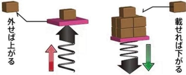
バネを使用した構造で荷物を外せば上がり、荷物を載せれば下がるといったように、常に同じ高さにあるため**作業者のかがむ作業を軽減でき、腰痛対策に繋がります。**
