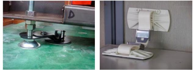
生産設備が災害により転倒しないよう、製品部材や原料などが棚から落下しないようストッパー設置。
